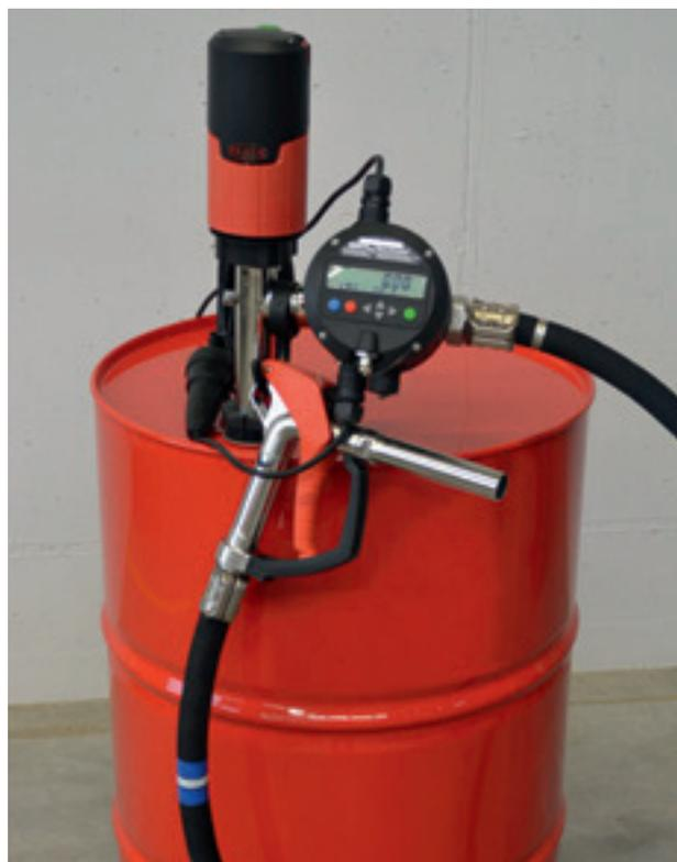
Application classique de pompe vide-fûts avec compteurs de débit FMO 104, amplificateur de commutation FSV 100, tuyau et pistolet de distribution pour un remplissage semi-automatique.
