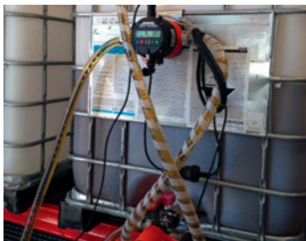
Remplissage semi-automatique à partir d'un conteneur IBC avec un compteurs de débit FMC 100 et un amplificateur de commutation FSV 100.
