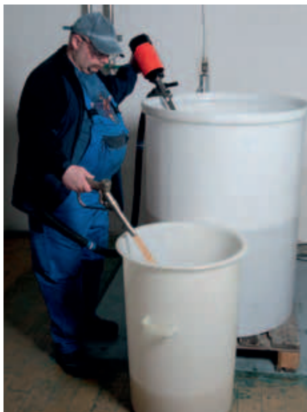
Simplement tourner le levier de commande et le fluide peut être rapidement pompé.
