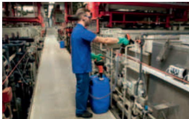
COMBIFLUX avec moteur sur batterie – la solution lorsque la pose de câbles n'est pas souhaitée ou qu'elle pose problème.
