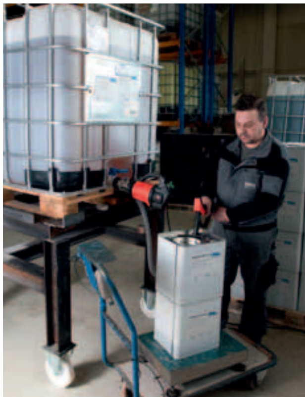
Remplissage rapide dans un bidon via l'écoulement sur l'IBC.
