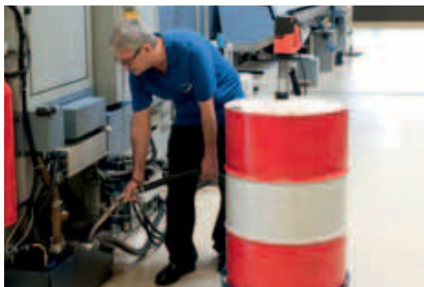
Remplissage d'une installation avec de l'huile hydraulique (F 430 AL).
