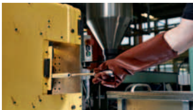
Production du tube intérieur renforcé avec un cœur en métal pour les versions en plastique.
