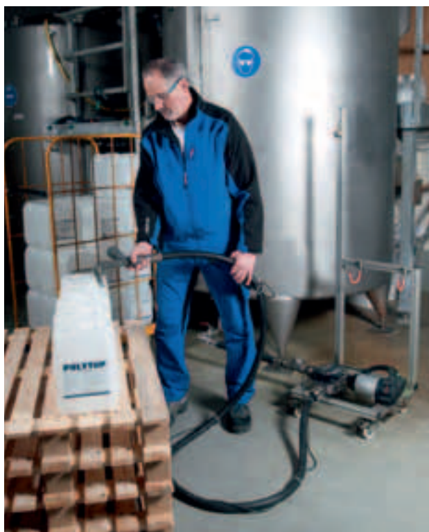
Remplissage d'un produit nettoyant à partir d'un haut réservoir dans le bidon.
