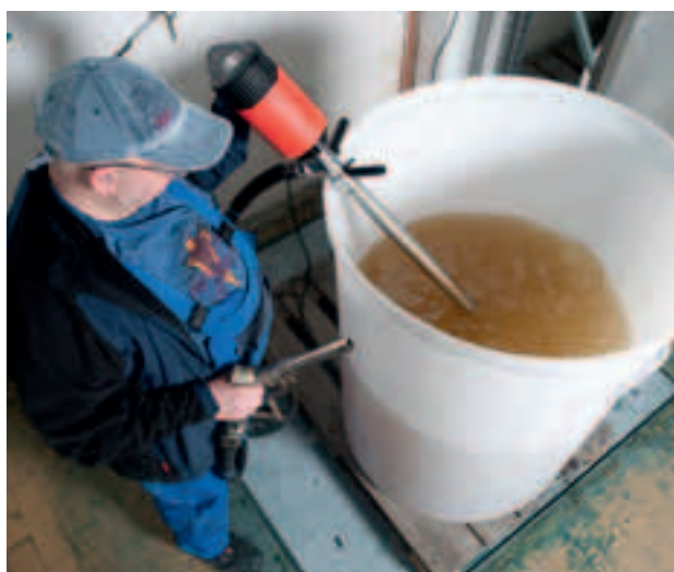
Avec le F 426, les fluides non homogènes peuvent être brièvement mélangés avant le remplissage.
