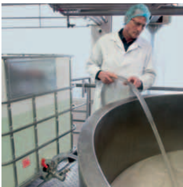
Transfert d'un fluide via l'écoulement sur l'IBC, vers le haut dans un mélangeur.
