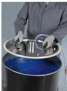
Montage du plateau-suiveur avec joint de process.\*
